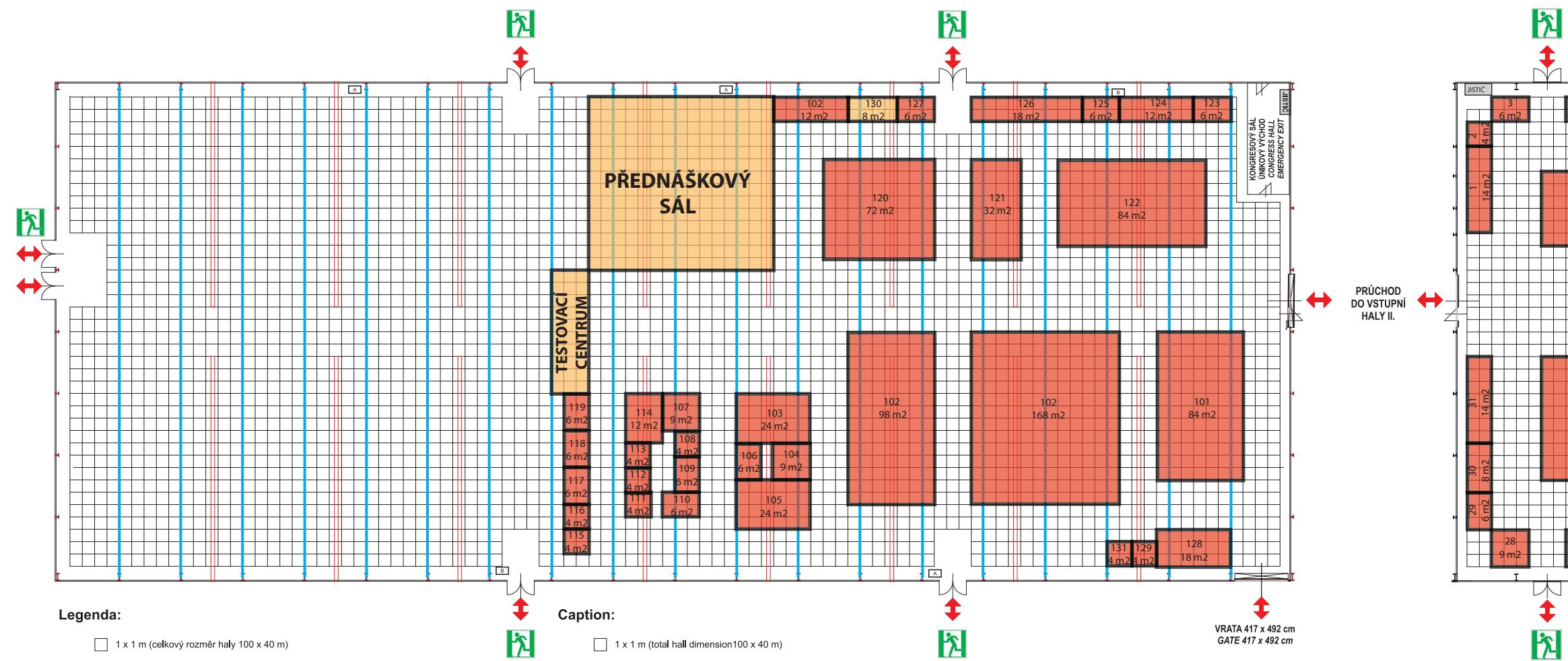
**A**: Topné těleso A - ve výšce 3,5m, od betonového kraje haly k přednímu panelu vzdálenost 0,9m
